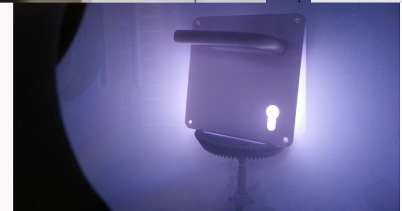
Proceso de recubrimiento mediante plasma en vacío de una manilla de puerta realizado en Eurecat
